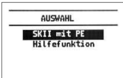
Mit der Bestätigung der Auswahl „SKII mit PE“ („START“-Taste >2 s) wird das Gerät auf vorgenannte Messung konfiguriert.
