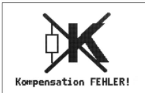
Danach erfolgt die Speicherung einer fehlerhaften Kompensation.
