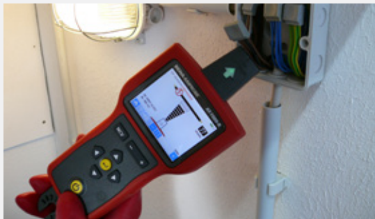
Jäljitä jännitteiset tai jännitteettömät johdot poistamalla jakorasian kansi.
