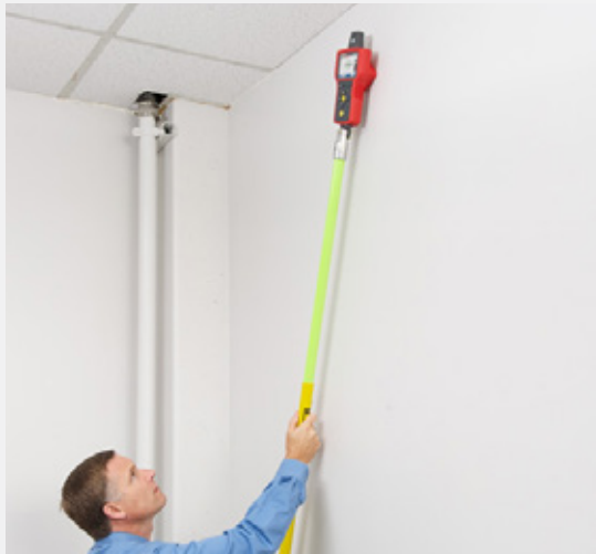
Eristetty sauva johtojen tunnistukseen vaikeapääsyisistä paikoista
