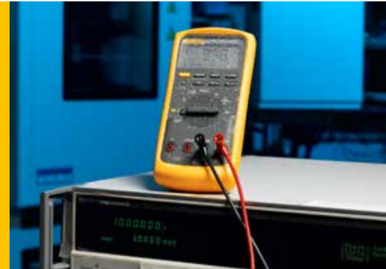
Ett mätinstrument, just utplockat ur testkammaren med en temperatur på -20 °C, mäter upp 1 000 volt och 1 KHz täckt av is.
