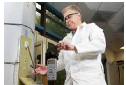
Falltestet. Ett mätinstrument med specificerad driftstemperatur på -10 till 50 °C, som Fluke 179, kommer att släppas från en meters höjd på alla sex sidor, först vid -10 °C och sedan vid 50 °C.
