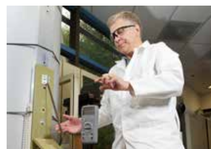
Testul de cădere. Un aparat de măsură cu specificațiile de la -10 la 50 °C, cum este Fluke 179, va fi lăsat să cadă de la 1 metru pe toate cele șase fețe, la -10 °C și din nou la 50 °C.
