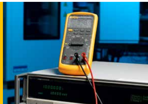
Miernik od razu po wyjęciu z komory o temperaturze -20^{\circ}\text{C} , mierzy napięcie 1000 V AC 1 kHz, jeszcze pokryty lodem.
