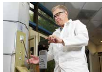
Próba upadkowa. Miernik przewidziany do pracy w temperaturach od -10 do 50^{\circ}\text{C} , jak np. Fluke 179, jest zrzucony z wysokości 1 metra na każdy z sześciu boków w temperaturze -10^{\circ}\text{C} , następnie ponownie w temperaturze 50^{\circ}\text{C} .
