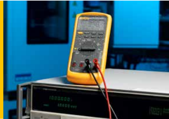
Et måleinstrument, rett fra testkammeret som holder -20^{\circ}\text{C} , er dekket av is mens det måler 1000 volt AC1KHz.
