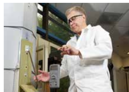
Falltesten. Et måleinstrument med bruksområde fra -10 til 50 °C, som f.eks. Fluke 179, blir sluppet fra 1 meters høyde på alle seks sider ved -10 og ved 50 °C.
