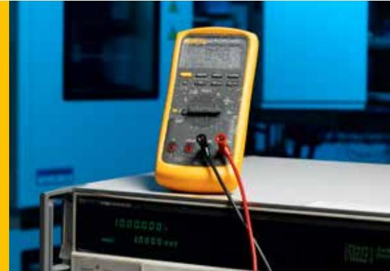
Ein Messgerät direkt nach der Prüfkammer bei  $-20^{\circ}\text{C}$ , das 1.000 Volt Wechselspannung bei 1 KHz misst, während es mit Eis bedeckt ist.
