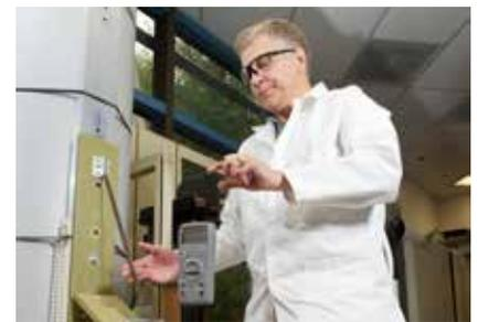
Der Falltest: ein Messgerät, das auf den Bereich  $-10$  bis  $+50\text{ °C}$  ausgelegt ist, wie Fluke 179, wird bei  $-10\text{ °C}$  und erneut bei  $+50\text{ °C}$  aus einem Meter Höhe auf alle sechs Seiten fallen gelassen.
