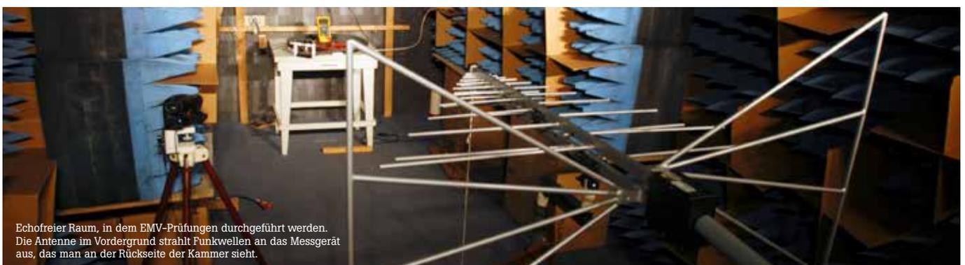
Echofreier Raum, in dem EMV-Prüfungen durchgeführt werden. Die Antenne im Vordergrund strahlt Funkwellen an das Messgerät aus, das man an der Rückseite der Kammer sieht.
