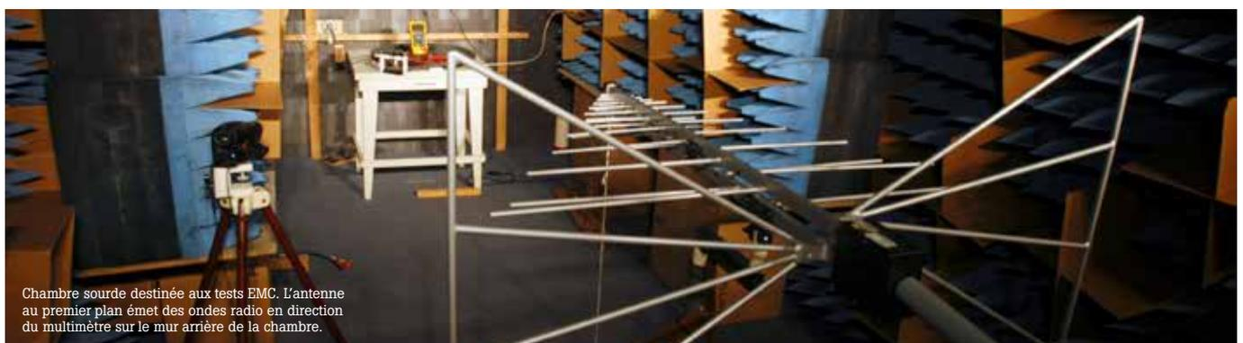
Chambre sourde destinée aux tests EMC. L'antenne au premier plan émet des ondes radio en direction du multimètre sur le mur arrière de la chambre.
