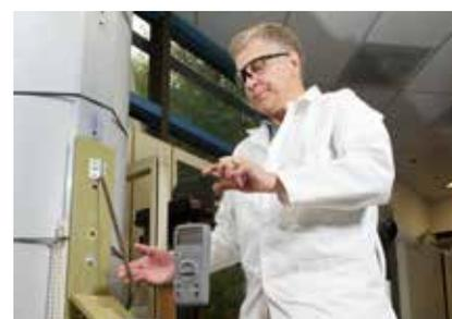
Le test de chute : un multimètre dont la température d'utilisation va de -10° à 50 °C, comme le modèle Fluke 179, sera l'objet d'une chute de 1 mètre sur ses six côtés à -10° et à 50 °C.
