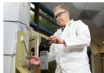
Faldtesten. Et meter, der er specificeret til -10 til 50 °C, f.eks. Fluke 179, tabes fra 1 meter på alle seks sider ved -10 og ved 50 °C.
