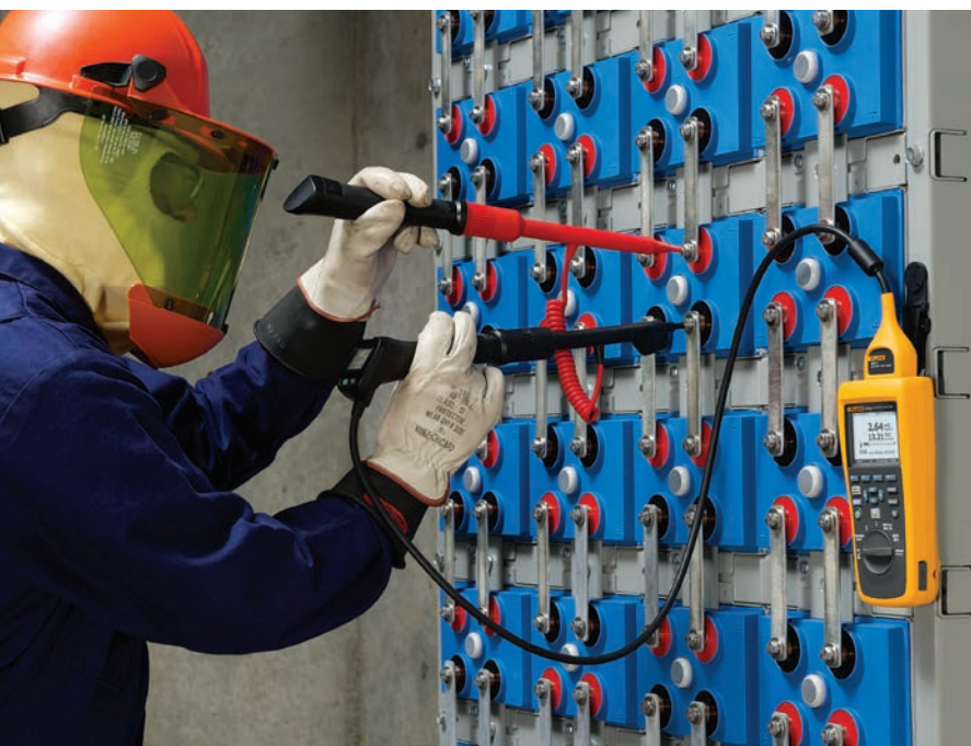
Måling av ohmske verdier i sekvensmodus
