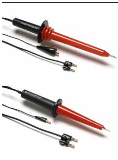
Figur 3. Tillbehör som högspänningsprober utökar den digitala multimeterens mätområde för spänning.
