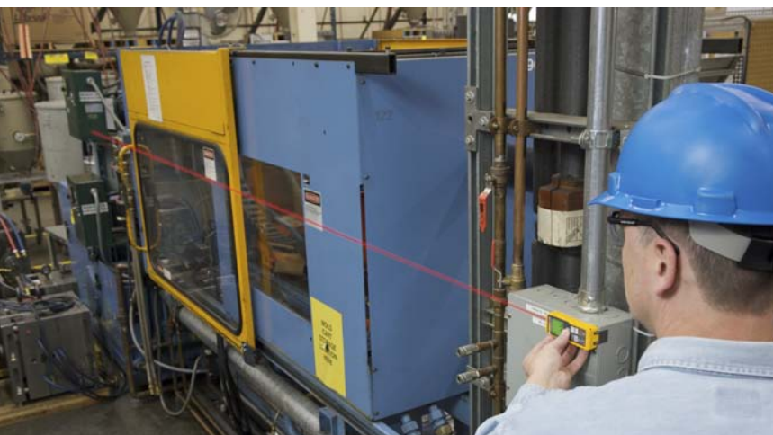
Calcolo dell'ingombro delle apparecchiature.
