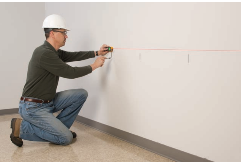
Cornière de butée adaptant le point zéro de l'instrument (seulement 421D).
