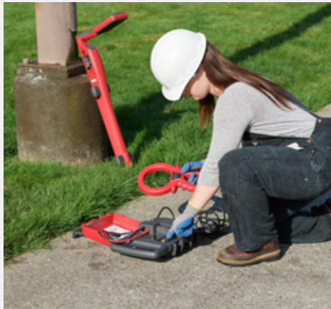
Lähetin vaihtaa tilaa automaattisesti sen mukaan, mikä lisävaruste laitteeseen on liitetty
