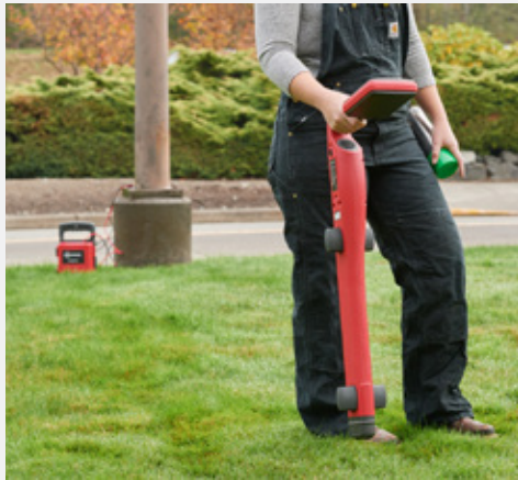
Jäljitä yksittäinen laite kytkemällä lähetin suoraan mittausjohtoihin
