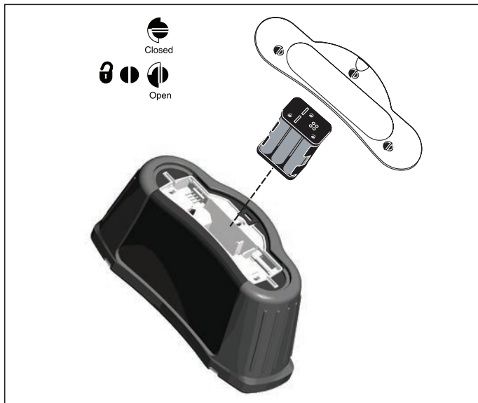
Figure 24. Remplacement des piles
