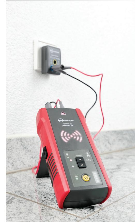
Per localizzare facilmente una linea, basta collegare il trasmettitore del localizzatore di cavi avanzato Beha-Amprobe all'adattatore di verifica delle prese ADPTR-SCT-EUR per tracciare la linea.
