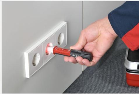
Test di prese a muro per tensione AC e polarità
