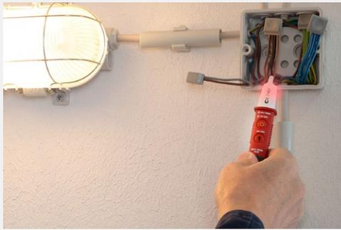
Test di cavi per tensione AC e rapida ricerca guasti
