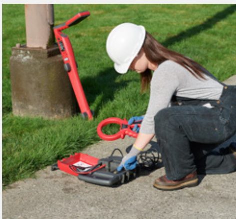
O transmissor irá alterar automaticamente os modos com base no acessório que está ligado
