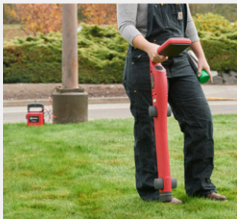
Rastreie uma instalação individual ligando o transmissor diretamente com os cabos de teste
