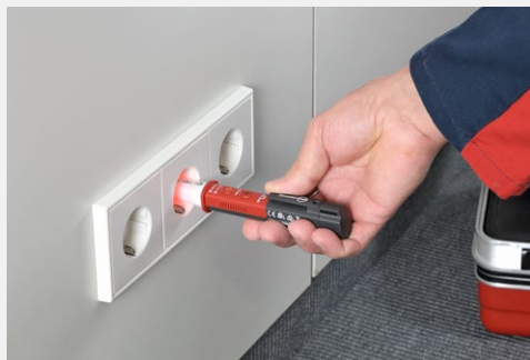
Tarkista jännitepistorasioista AC-jännite ja napaisuus
