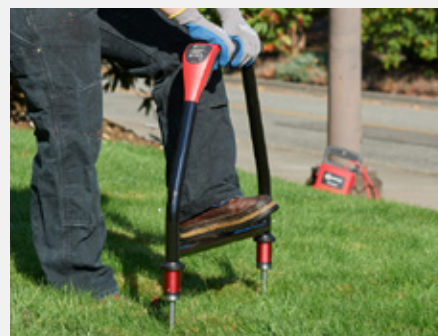
Precieze opsporing van storingslocaties door de AF-600-EUR te gebruiken in combinatie met de UAT-600-TE
