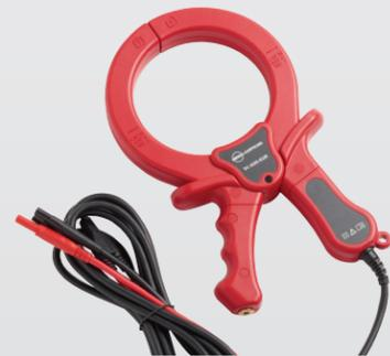
**Pinza SC-600-EUR** El accesorio de pinza de señal proporciona un método eficaz y seguro para aplicar una señal de localización a un cable, lo que permite al transmisor inducir una señal a los cables o tuberías a través del aislamiento. La pinza funciona únicamente en circuitos cerrados de baja impedancia.
