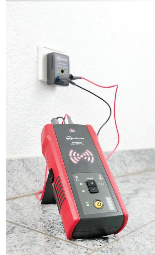
Conecte un transmisor de localizador de cables avanzado de Beha-Amprobe al adaptador para comprobación de tomas de corriente ADPTR-SCT-EUR para un fácil rastreo de la línea.
