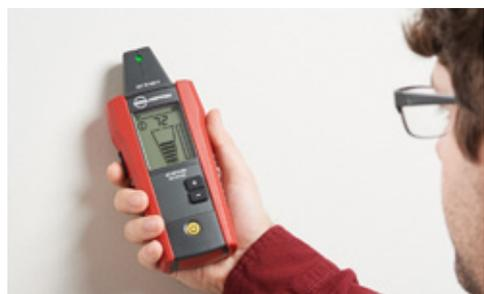
Suche nach spannungsführenden und spannungsfreien Leitungen
