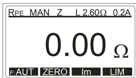
Figure 4: Mesures de la fonction RPE avec les câble de mesure compensés
